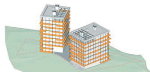
une façade flexible la dimension des balcons est définis par les acquéreurs
